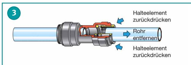
**Lösen der Verbindung des Ø 15 - 22 mm Systems**
