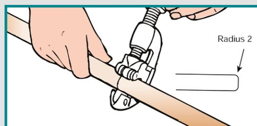
Das Rohr muss sauber mit einem Rohrschneider abgetrennt werden! Keine Säge verwenden!
