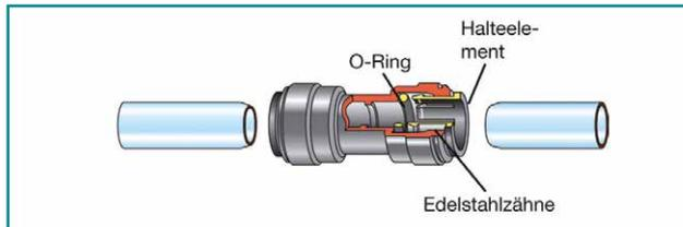
Die Produktreihe wird aus Acetalcopolymer (POM) hergestellt und besteht aus dem Verbinderkörper, Halteelementen mit Edelstahlzähnen sowie NBR-O-Ringen zur Abdichtung. Der Verbinder kann ohne den Gebrauch von Werkzeugen sowohl montiert als auch demontiert werden. **Die Verbindung hält, bevor sie abdichtet!**
