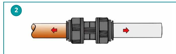
**Kontrolle der Verbindung durch Gegenziehen**
