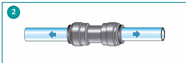
**Kontrolle der Verbindung durch Gegenziehen**
