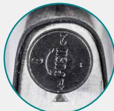
Einstellung des Drehmoments mittels Stellrad
