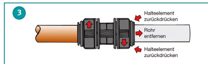
**Lösen der Verbindung des Ø 28 mm Systems**
