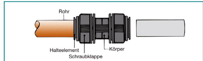
Das 28 mm System besteht aus dem Verbinderkörper, Halteelementen mit Edelstahlzähnen und NBR-O-Ringen. Durch zusätzliche Schraubkappen wird das Haltesystem gesichert und eine Verpressung der O-Ringe auf dem Rohr gewährleistet. Der Verbinder kann ohne den Gebrauch von Werkzeugen sowohl montiert als auch demontiert werden. **Die Verbindung hält, bevor sie abdichtet!**
